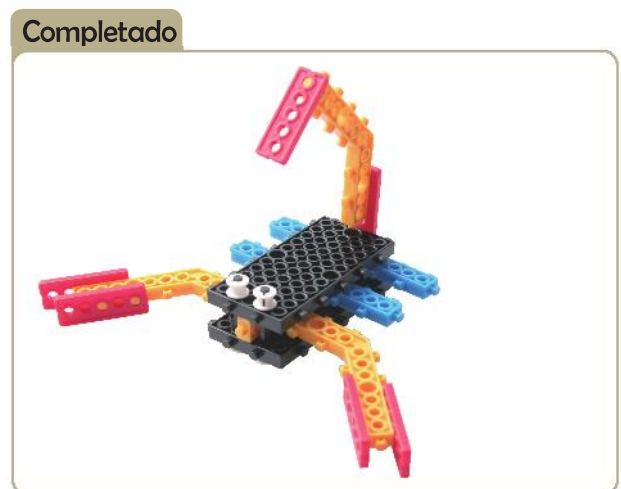
Haz los ojos del Escorpión usando ejes y cojinetes.
