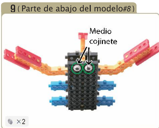
Conecta medios cojinetes en la parte de abajo del modelo #8.
